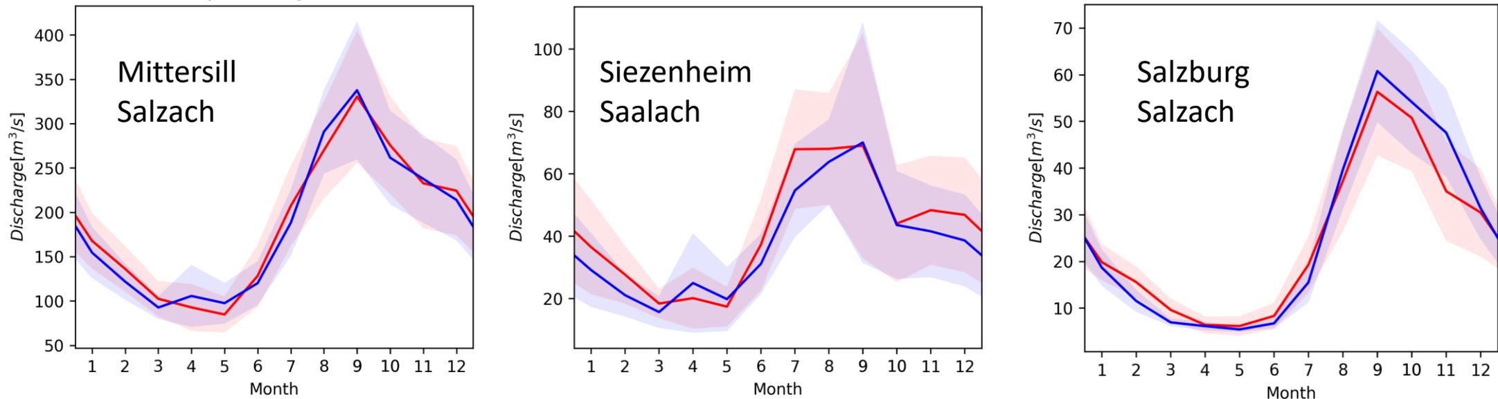
Das Modell wurde anhand der täglichen Abflüsse an mehreren Stationen im Salzburger Einzugsgebiet kalibriert. Durchschnittliche monatliche Abflüsse an drei Stationen mit **beobachteten Abflüssen in blau** und **simulierten in rot**. Die durchgezogene Linie zeigt den Durchschnitt von 2007 bis 2016, und die transparenten Bänder stellen den minimalen und maximalen Bereich dar.
